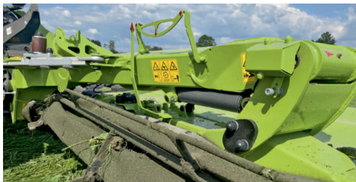
Ein Gelenk zwischen Ausleger und Mäheinheit verschiebt auf schmale, mittlere oder breite Position. Gut sichtbar aus der Kabine: Der rote Pfeil zeigt die Position der Mäheinheit an.
