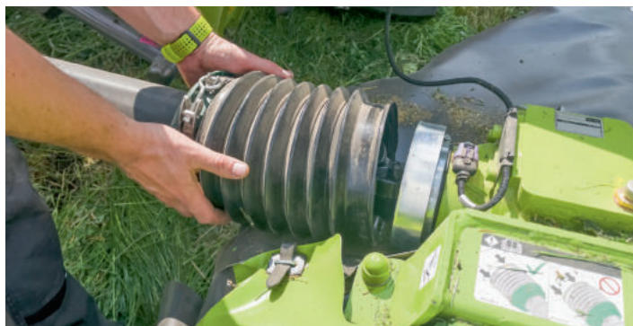
Alle 20 Stunden muss der Schutz mit einem Schnellverschluss ab, damit die Teleskopgelelenkwelle Schmierfett bekommt.
