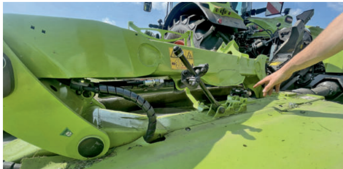
Eine Gleitbahn mit Rollen sorgt dafür, dass der Fahrer die Mäheinheiten auch in Vorgewendeposition verschieben kann.
